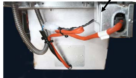
Фигура 3: Включете черното щепселно съединение в захранващата кутия, както е показано. Отделен кабелен сноп с бял щепсел, ако е налице, НЕ се използва.
